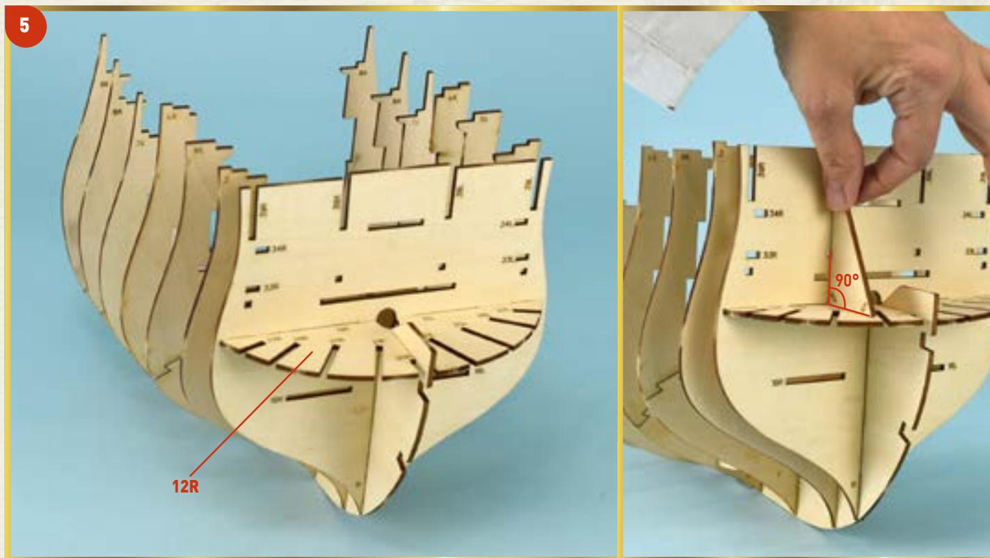
**5** Приклейте деталь (12R) к правой части носовой переборки, симметрично детали (12L). Спереди должно быть видно, что обе приклеенные детали лежат на одной горизонтальной линии.
