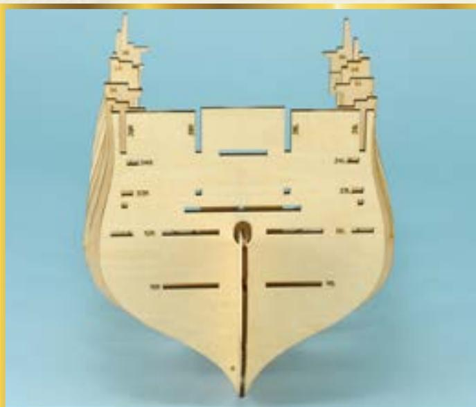
**2** Вклейте носовую переборку (11) в первый паз килевой рамки, при помощи шаблона убедившись, что обе детали образуют угол  $90^\circ$ . **Обратите внимание:** сторона переборки, на которую нанесена маркировка, должна быть обращена вперед.
